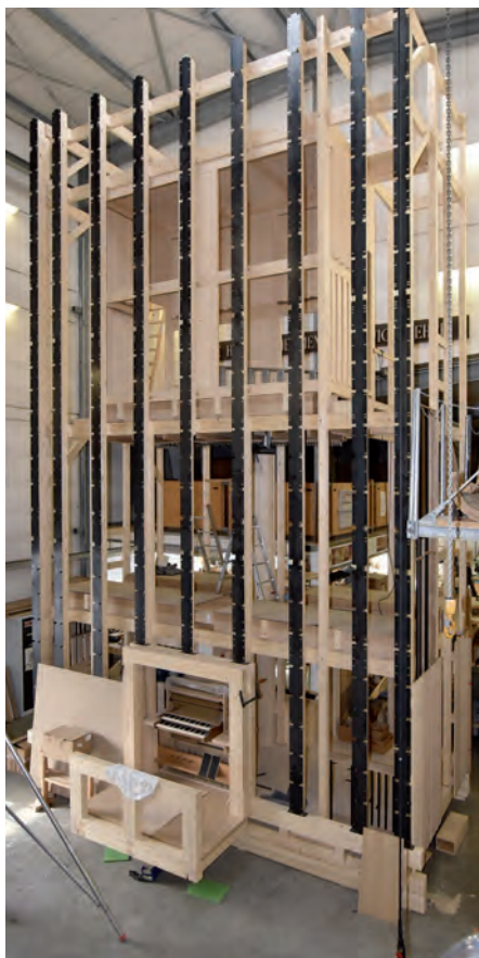
Bei der Firma Weimbs in Hellenthal in der Eifel bauen sie bereits an der neuen Orgel. Zu sehen ist das Rüstwerk. Foto: R. Schlitt
